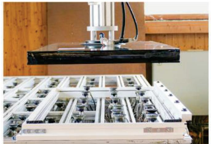
Die über den Flügel hinausragende Scheibe vereinfacht die Konstruktion beim Kleben. Die Tropfkante am Glas wird dadurch zwingend.
