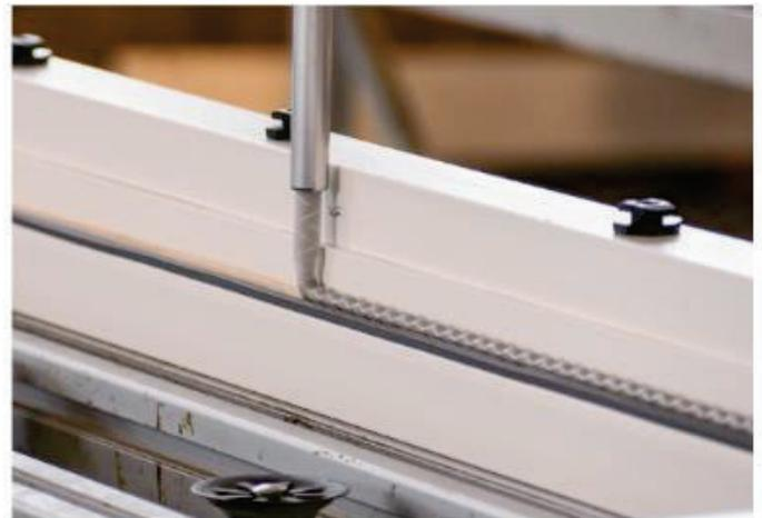
Das Glas wird automatisch eingelegt, muss aber dann noch exakt ausgerichtet werden.
